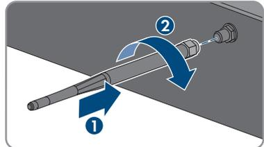
4. Durch leichtes Ziehen an der WLAN-Antenne sicherstellen, dass die WLAN-Antenne fest sitzt.
