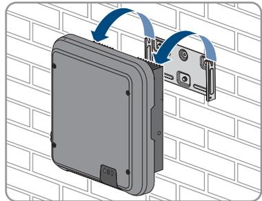
16. Die Schrauben zur Befestigung der Wandhalterung herausdrehen und Wandhalterung abnehmen.
