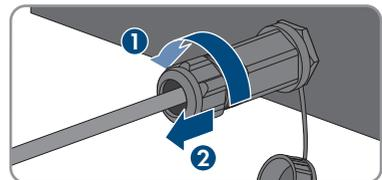
6. Gewindehülse von dem Gewinde der Netzbuchse am Wechselrichter abdrehen und abnehmen.
