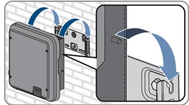
7. Sicherstellen, dass der Wechselrichter fest sitzt.
