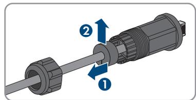
9. Das Netzkabel aus der Gewindehülse und der Überwurfmutter herausführen.
