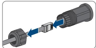
10. Schutzkappe auf Netzbuchse drehen.
