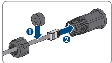
5. Kabeltülle in die Gewindehülse drücken.
