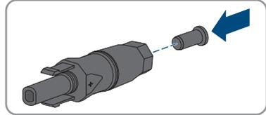
12. Die DC-Steckverbinder mit Dichtstopfen in die zugehörigen DC-Eingänge am Wechselrichter stecken.
