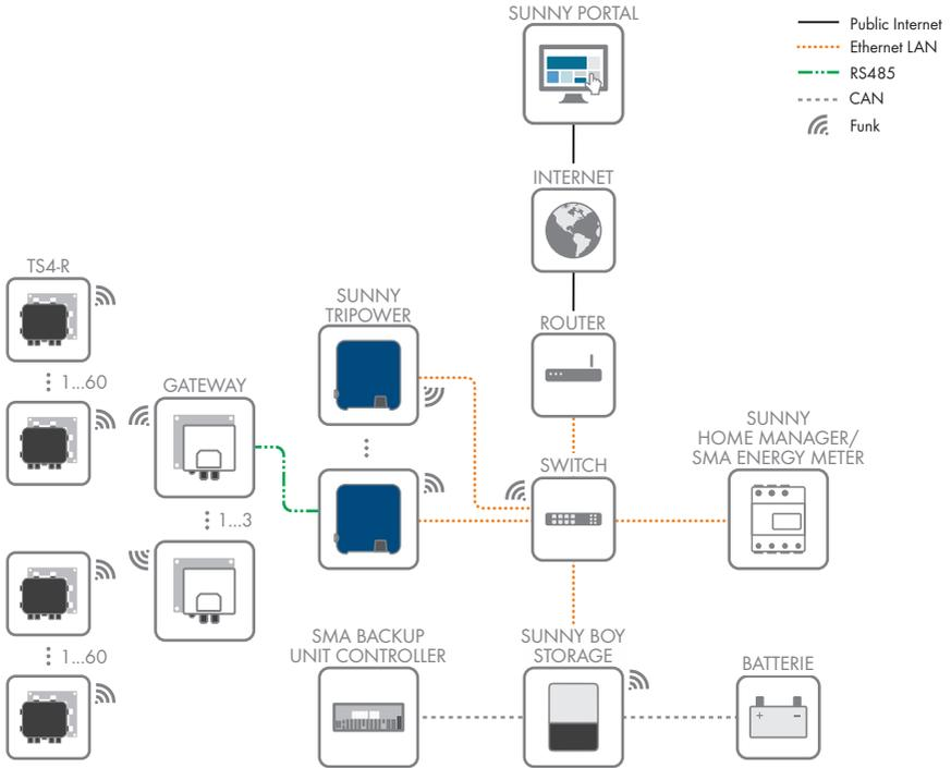
Abbildung 4: Aufbau Anlagenkommunikation
