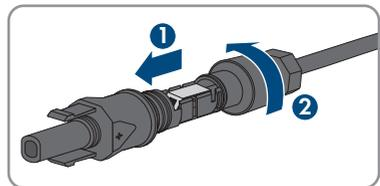
5. Überwurfmutter bis zum Gewinde schieben und festdrehen (Drehmoment: 2 Nm).
