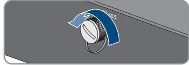
5. Den M12-Stecker in die Buchse für den RS485-Kommunikationsanschluss stecken und festdrehen. Dabei den Stecker so ausrichten, dass die Führungsnase der Buchse am Wechselrichter in die Führungsnut am Stecker eingeführt wird.
