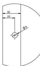
Détail perçage pour fixation
