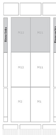
Erweiterungs-Set vertikal für eine weitere Modulzeile
