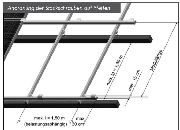
Die max. Spannweite des Unterprofils zwischen zwei Stockschrauben beträgt 1,50 m. Bei hoher Belastung, wie z.B. bei einer Geländehöhe von mehr als 500 m über Normalnull, reduziert sich die max. Spannweite des Unterprofils auf 85 cm. Entnehmen Sie die genauen Angaben bitte den Tabellen auf Seite 22.
