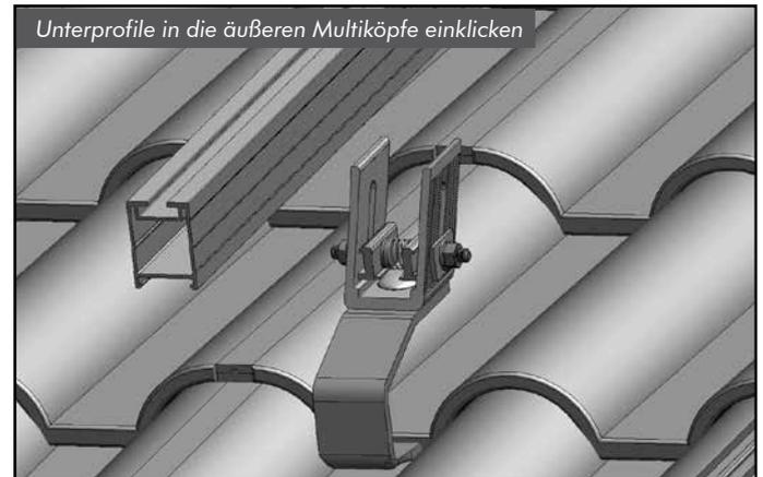
Befestigen Sie zunächst die äußeren (ortgangseitigen) Unterprofile. Achten Sie darauf, dass die nebeneinander liegenden Profile in einer Flucht liegen.
