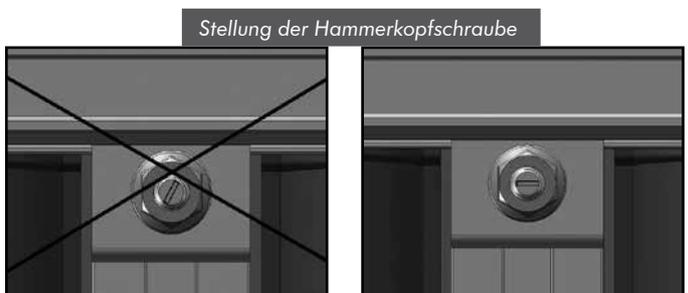
Achten Sie darauf, dass die Hammerkopfschraube nach dem Einführen in die Nut des Unterprofils um 90° gedreht wird. Die Kerbe am Schraubenende ermöglicht Ihnen eine optische Kontrolle. Richten Sie das Profil exakt aus und ziehen Sie dann die Mutter auf der Hammerkopfschraube M8 mit einem Anzugsmoment von 16 Nm fest an.
