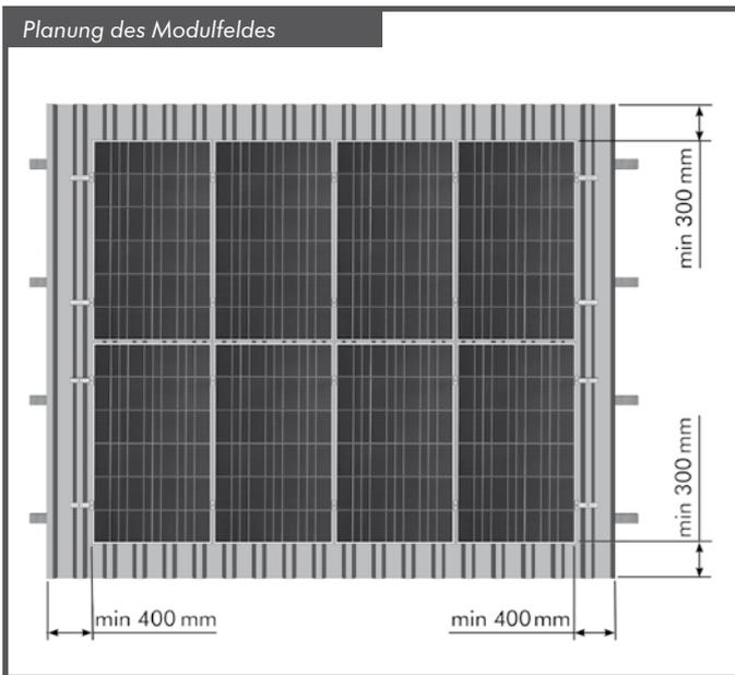
Platzieren Sie das Modulfeld so, dass es rechts und links mindestens 40 Zentimeter vom Ortgang entfernt ist. Der Abstand bis zum First und zur Traufe darf jeweils 30 Zentimeter nicht unterschreiten.
