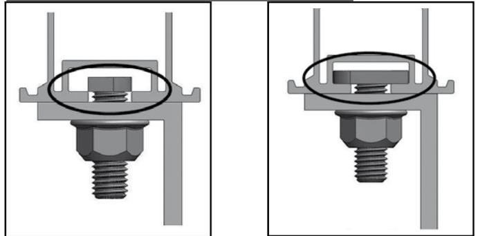
Legen Sie das Profil auf. Bringen Sie die Hammerkopfschrauben in die Nut ein. Drehen Sie diese 90° in Uhrzeigerichtung. Richten Sie die Profile der Länge nach aus und ziehen die Mutter mit 32 Nm an. Befestigen Sie alle Profile auf den restlichen U-Adaptern wie zuvor beschrieben.
