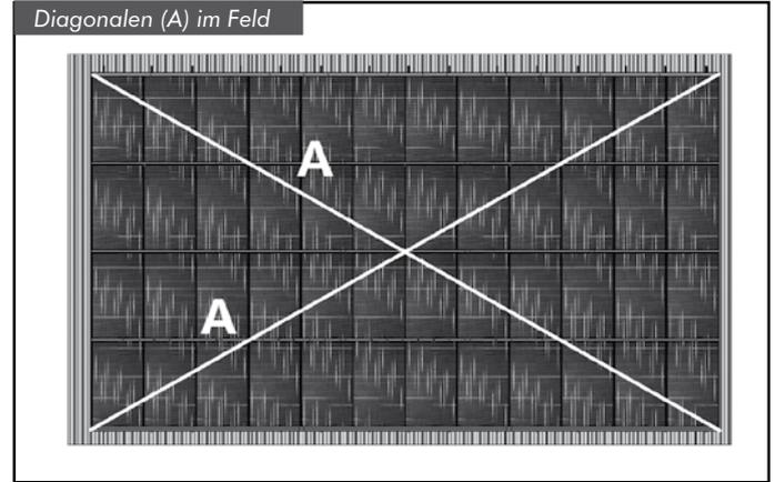
Achten Sie darauf, dass die seitlichen Enden der Oberprofile in einer Flucht liegen. Die beiden Diagonalen (A) im Feld – gemessen an den Enden der außen liegenden Oberprofile – müssen gleich lang sein. Nach korrekter Lagepositionierung aller Oberprofile ziehen Sie die Schrauben der Kreuzplatten mit einem Anzugsmoment von 16 Nm an.
