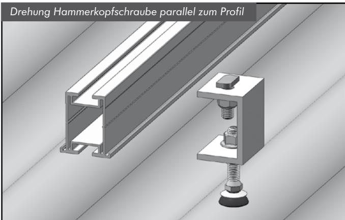
Drehen Sie die Köpfe der Hammerkopfschrauben parallel zum einzulegenden Profil.
