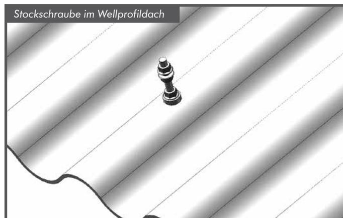
Die Befestigung erfolgt sowohl bei Wellprofildächern als auch bei Trapezblechdächern auf dem Wellenberg bzw. der Hochsicke. Vor eindringendem Regenwasser schützt ein EPDM-Dichtring (Wellprofil) bzw. eine Kalotte (Trapezblech).
