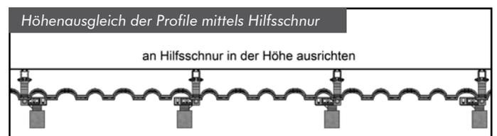
Vor dem Anziehen der seitlichen Schrauben können Sie das Profil in die gewünschte Höhenposition am Multikopf ziehen. Durch die Höhenverstellung des Profils am Multikopf können Sie Dachunebenheiten bis zu 35 mm ausgleichen. Verwenden Sie den „Multikopf lang“ zur Erweiterung des Verstellbereichs bis auf 70 mm.
