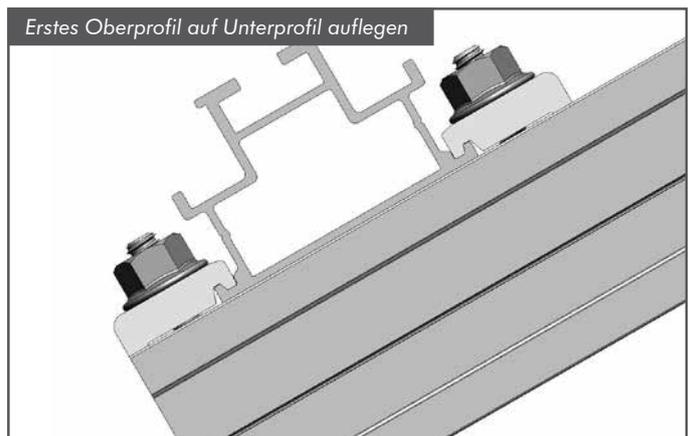
Fixieren Sie das Profil mittels der Kreuzplatten. Hängen Sie die Kreuzplatten beidseitig des Oberprofils jeweils mit der Nase in den Fuß des Oberprofils ein und verschrauben Sie diese mittels Hammerkopfschraube.
