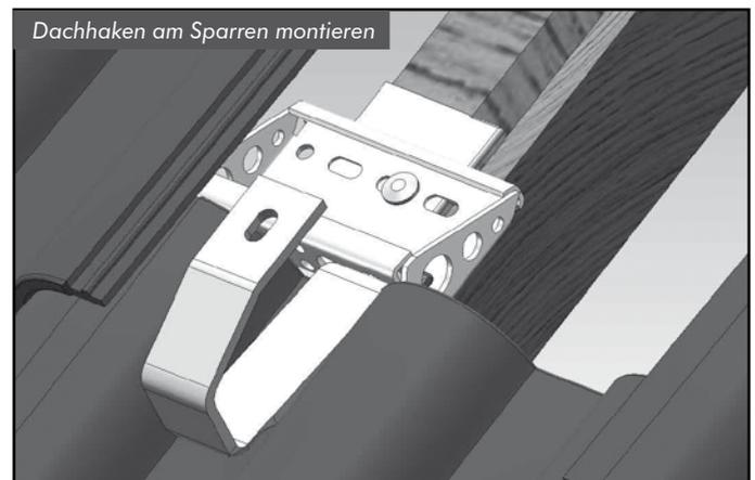
Wählen Sie die Position des Dachhakens auf dem Sparren bzw. der Konterlatte so, dass der Ausleger immer im Tal des Ziegels liegt.
