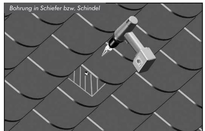
Bohren Sie an der Position des Dachsparrens, die Schiefer bzw. Schindel mit einem Kegelbohrer auf einen Durchmesser von 19-20 mm auf. Setzen Sie die Bohrung in das obere Drittel der Schiefer- bzw. Schindelabdeckung.
