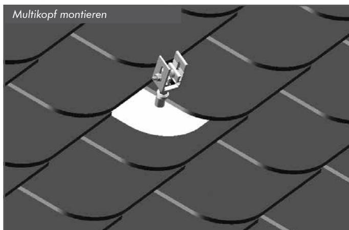
Schrauben Sie den Multikopf Stockschrabe Fix auf die Gewindestange auf und kontern Sie mit der zweiten vormontierten Mutter.
