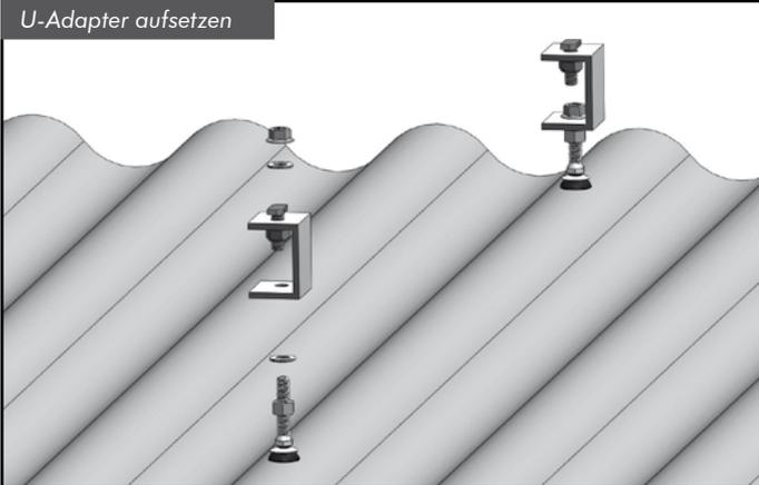
Setzen Sie den U-Adapter auf. Richten Sie ihn mit Hilfe einer Hilfsschnur in der Höhe aus und ziehen Sie die obere Mutter an. Kontern Sie dann mit der unteren Mutter.
