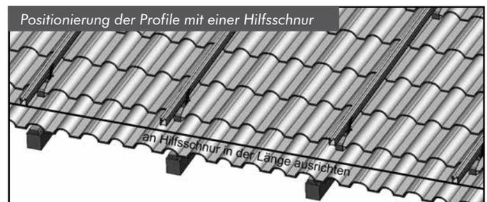
Verwenden Sie zur Positionierung der innen liegenden Profile eine Hilfsschnur.
