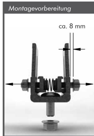
**!** Beachten Sie bitte die Montagevorbereitung. Lösen Sie zuerst die Schraubenverbindung der Innenklammern am Multikopf. Montieren Sie die Multiköpfe lose auf den Auslegern der Dachhaken. Drehen Sie die Multiköpfe so in Position, dass Sie die Unterprofile parallel zum Ortgang von oben in das U-Profil des Multikopfes einlegen können. Verwenden Sie einen Momentenschlüssel zum Anziehen der unteren Schraube M10. Ihr Anzugsmoment beträgt 32 Nm.
