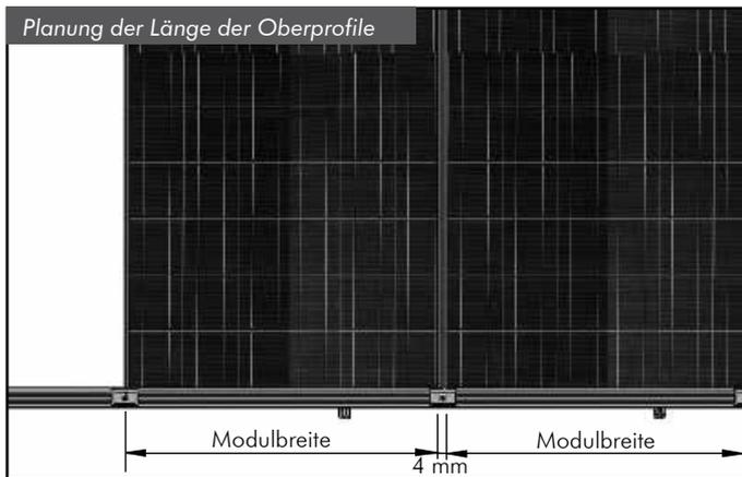
Die Mindestlänge der Oberprofile errechnet sich aus der Breite und Anzahl der nebeneinander liegenden Module sowie dem Abstand zwischen den Modulen von 4 mm. Die Länge der Oberprofile ist so auszulegen, dass Profilanfang und Profilende immer über einem Sparren liegen und somit die Anbindung an die Unterprofile sichergestellt ist. Der maximale Überstand der Oberprofile über einen Dachhaken hinaus beträgt  $< 30$  cm. Ggf. sind die Oberprofile bis auf den nächsten Sparren zu verlängern.
