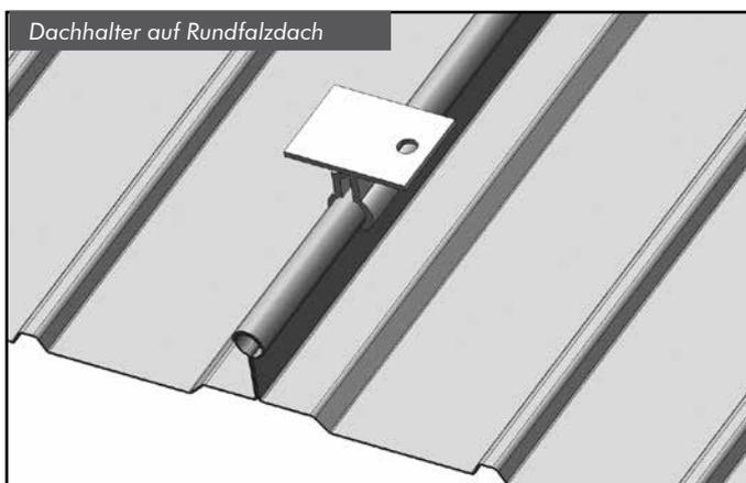
Die Dachhalter sind in der Regel auf jedem Falz zu montieren. Montieren Sie die Stehfalzklemme so, dass die Klemmfläche vollständig auf dem Stehfalz aufliegt.
