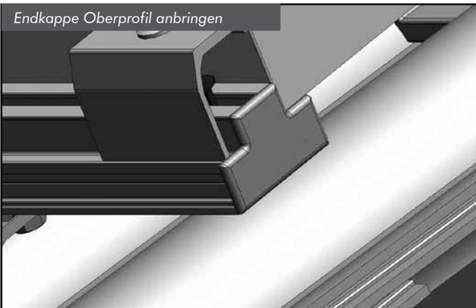
Bringen Sie die Endkappen an die Unter- und Oberprofile an. Diese lassen sich von Hand in die Profildenden stecken und fest drücken.
