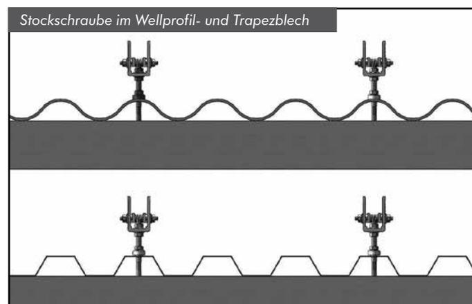
**!** Um neue Bohrungen in der Dachhaut zu vermeiden, sollten Sie prüfen, ob mit den Stockschraben bereits vorhandene Dachbefestigungsschrauben ersetzt werden können. Nach entsprechender Vorplanung werden die Pfetten vorgebohrt und die Stockschraben eingeschraubt. Das Holzgewinde muss aus Festigkeitsgründen komplett in das Holz eingeschraubt werden. Das metrische Gewinde steht oberhalb der Dachhaut heraus. Beachten Sie bei der Montage die Holzbaunorm DIN 1052.
