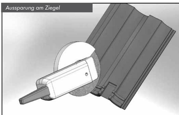
Nehmen Sie an der Stelle der Durchführung des Dachhakens zwischen den Ziegeln mittels Trennschleifer am Ziegel entsprechende Aussparungen vor. Gegebenenfalls können Sie spezielle Dachziegel aus Kunststoff oder Metall einsetzen. Achten Sie darauf, dass die Dachziegel auch nach Anbringen der Dachhaken möglichst dichtend auf dem Dach aufliegen.
