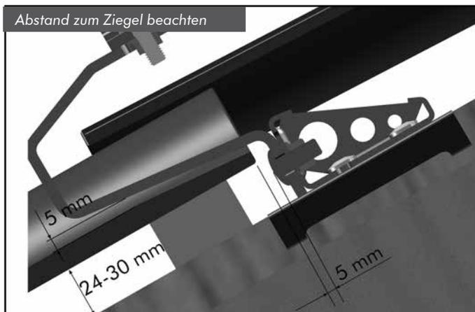
Der Ausleger kann bei Bedarf rechts oder links an der Grundplatte montiert werden. Beachten Sie die Einbaumaße des abgebildeten „Standard“-Dachhakens. Er ist für Dachlattehöhen von 24 - 30 mm geeignet.
