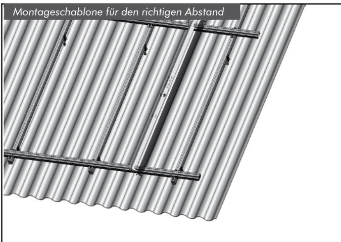
Montieren Sie die weiteren Profile am besten mit der Montageschablone (Art. 12 00 125 00), mit Hilfe einer Abstandsleiste oder einem Zollstock im richtigen Abstand zueinander. Das lichte Maß errechnen Sie aus der Modullänge sowie einer Längentoleranz von zusätzlich 4 mm.
