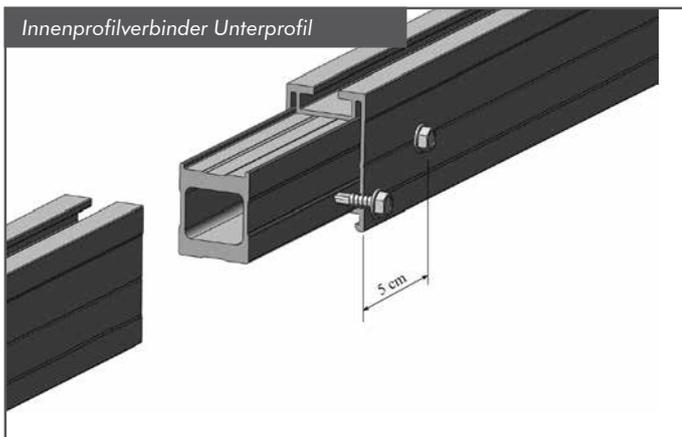
Die Profile können Sie durch den Einsatz von Innenverbindern verlängern. Schieben Sie diese dazu in die beiden zu verbindenden Profile jeweils 10 cm ein. Schrauben Sie bei einer starren Profilverbindung auf jeder Seite des Profilstoßes je eine Blechbohrschraube 5,5x19 ein. Die Position der Schrauben liegt auf der vorgesehenen Profiltrille in einem Abstand von ca. 5 cm vom Profilstoß.
