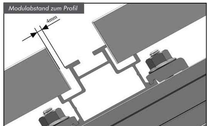
Beginnen Sie bei der Montage der Module mit der obersten Reihe. Legen Sie die Solarmodule in die Oberprofile ein. Der seitliche Abstand zwischen den Solarmodulen sollte 4 mm betragen, an der Oberseite sind 4 mm Spielraum einzuhalten.
