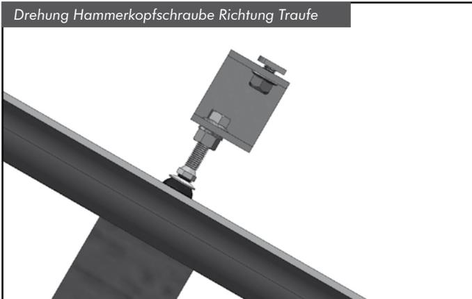
! Die Hammerkopfschraube des U-Adapters muss Richtung Traufe zeigen.
