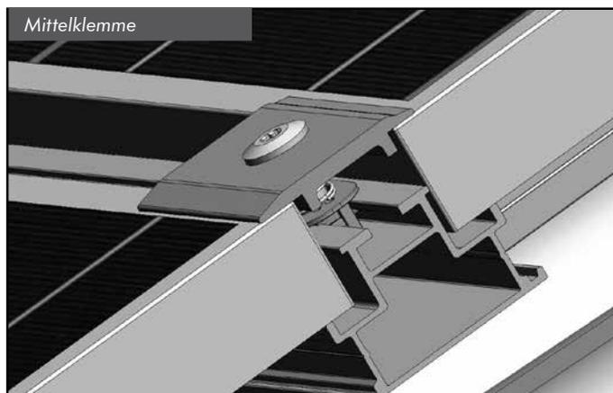
Zwischen den Modulreihen werden Mittelklemmen montiert. Wegen des Spielraums ist die Auflagefläche der Mittelklemme an ihrer Unterseite entsprechend länger. Als Montageorientierung dient die eingearbeitete Sichtkante an einer Seite der Klemme. Die muss immer in Richtung Dachfirst zeigen. Den unteren Abschluss bildet wieder die Endklemme.
