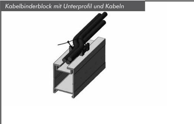
Befestigen Sie die Leitungen entlang der Profile mittels UV-beständigen Kabelbindern, Kabelbinderblöcken oder Kabelclips so, dass die Leitungen nicht durchhängen oder auf dem Dach aufliegen.
