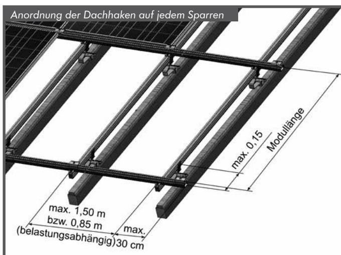
Die maximale Spannweite des Oberprofils zwischen zwei Dachhaken beträgt 1,50 m. Bei Sparrenabständen, die größer als 75 cm sind, bringen Sie auf jedem Sparren einen Dachhaken an. Bei hoher Belastung, wie z.B. bei einer Geländehöhe von mehr als 500 m über Normalnull reduziert sich die maximale Spannweite des Oberprofils auf 85 cm.
