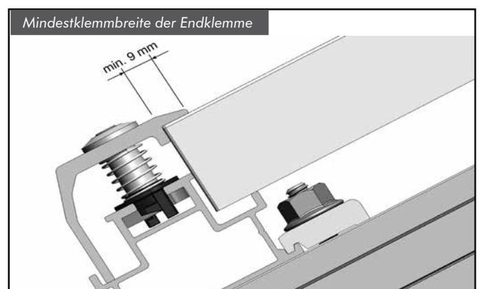
Setzen Sie die obere Endklemme mit der Hammerkopfschraube in die Nut des Oberprofils ein. Klemme leicht nach unten drücken und die Hülsenmutter im Uhrzeigersinn um 90° drehen bis die Klemme einrastet. Achten Sie darauf, dass die Mindestklemmbreite von 9 mm auf den Solarmodulrahmen wirkt. Beachten Sie unbedingt die Vorgaben für die Klemmbereiche der Modulhersteller.
