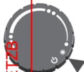
Ajustar el conmutador rotativo a la posición de protección contra heladas. El indicador de estado se ilumina permanentemente en naranja siempre que la temperatura del acumulador no descienda por debajo de  $4\text{ }^{\circ}\text{C} \pm 3\text{ K}$ .
