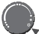
Régler le sélecteur rotatif en position ETEINT. La communication avec le correspondant réseau fonctionne, aucune puissance n'est enclenchée.
