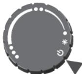
Ajustar el conmutador rotativo a la posición OFF. Se establece comunicación con la estación remota; ninguna potencia activa.
