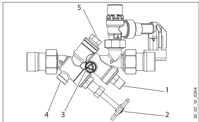
1 Контрольный прибор для клапана обратного потока (2-й запорный вентиль)
