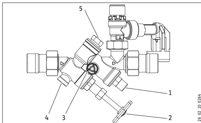
1 Zkušební zařízení zamezovače zpětného toku (2.uzavírací ventil)
