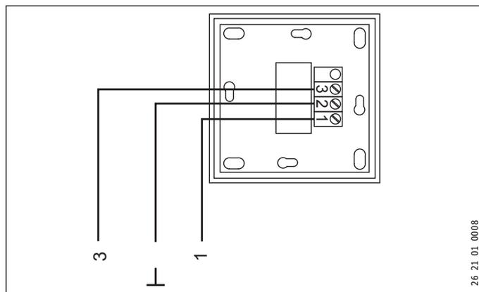
Avec la commande à distance FE 7, vous pouvez modifier la température ambiante de consigne du circuit de chauffage 1 de  $\pm 5$  °C. Cette fonction est seulement active en MODE PROGRAMMATION. Vous pouvez en outre modifier le mode de fonctionnement.
