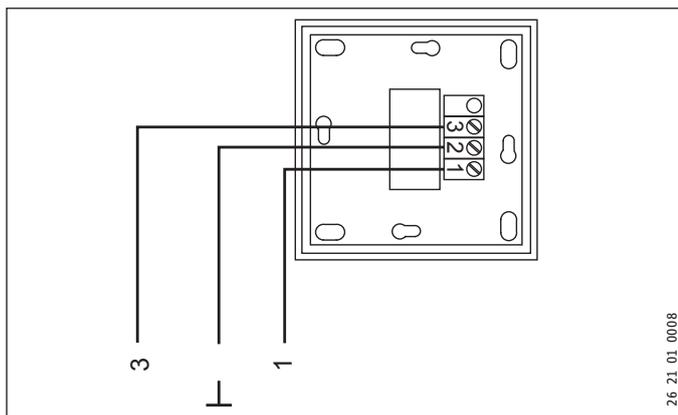
Mit der Fernbedienung FE 7 können Sie die Raum-Soll-Temperatur für den Heizkreis 1 um  $\pm 5\text{ °C}$  verändern. Diese Funktion ist nur im PROGRAMMBETRIEB aktiv. Zusätzlich können Sie die Betriebsart verändern.
