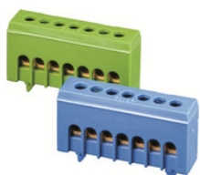
GHV0360876R0012 SZ-N11/3C Neutralleiterklemme 11x16qmm,einseit.geschl.,isoliert
