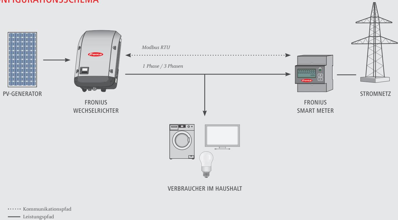
Der Fronius Smart Meter ist mit allen Wechselrichtern mit RS485-Schnittstelle (Modbus RTU) kompatibel. Bei den Wechselrichtern Fronius IG Plus funktioniert der Fronius Smart Meter in Kombination mit dem Fronius Datamanager 2.0. In bereits installierten Wechselrichtern kann der Fronius Smart Meter in Kombination mit dem Fronius Datamanager 2.0 jederzeit nachgerüstet werden.
