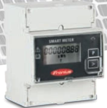
Der Fronius Smart Meter ist ein bidirektionaler Zähler zur Optimierung des Eigenverbrauchs und zur Erfassung der Lastkurve des Haushalts. Dank hoher Messgenauigkeit und schneller Kommunikation über die Schnittstelle Modbus RTU wird bei Einspeisebegrenzungen eine schnellere und genauere dynamische Einspeiseregulierung als bei 50-Zählern ermöglicht.
