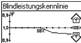
1. ➤ Die zuvor eingestellte Blindleistungskennlinie wird grafisch angezeigt (Bsp. in Abb. links).
