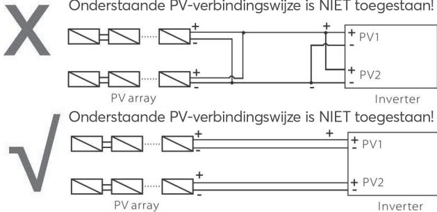
Onderstaande PV-verbindingswijze is NIET toegestaan!
