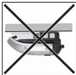
Den Wechselrichter nicht an der Decke montieren.
