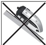
Den Wechselrichter nicht auf einer schrägen Fläche mit den Anschlüssen nach oben montieren.
