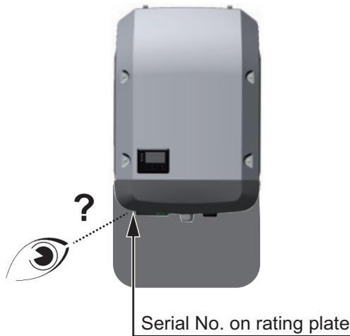
Die Seriennummer des Wechselrichters befindet sich auf dem Leistungsschild an der Unterseite des Wechselrichters. Je nach Montageposition kann die Seriennummer schwer zugänglich oder lesbar sein, z.B. wenn der Wechselrichter in einem dunklen oder schattigen Bereich montiert wurde.
