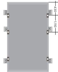
Max. zulässige Drucklast bis 3.600 Pa (Testlast 5.400 Pa)
