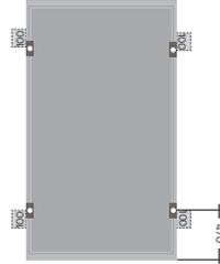
Max. zulässige Drucklast bis 2.400 Pa (Testlast 3.600 Pa)
