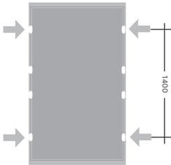
Max. zulässige Drucklast bis 2.400 Pa (Testlast 3.600 Pa)
