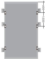
Max. zulässige Drucklast bis 1.067 Pa (Testlast 1.600 Pa)
