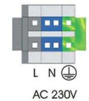
Leitungsquerschnitt: 1,5 - 2,5 mm<sup>2</sup>
