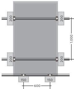
Max. empfohlene Drucklast am Modul: 5.400 N/m<sup>2</sup>
