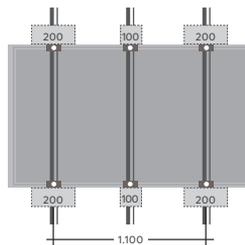
Max. empfohlene Drucklast am Modul: 5.400 N/m<sup>2</sup>
