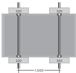
Max. empfohlene Drucklast am Modul: 2.800 N/m<sup>2</sup>
