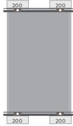
Max. empfohlene Drucklast am Modul: 2.400 N/m<sup>2</sup>
