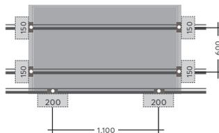
Max. empfohlene Drucklast am Modul: 5.400 N/m<sup>2</sup>
