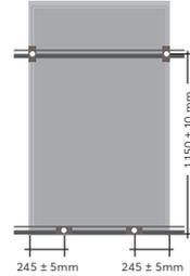
Max. empfohlene Drucklast am Modul: 3.600 N/m<sup>2</sup>
