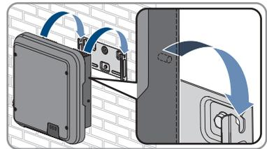
7. Sicherstellen, dass der Wechselrichter fest sitzt.
