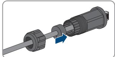
6. Den Netzwerkstecker des Kabels in die Netzwerkbuchse am Wechselrichter stecken und die Gewindehülse auf das Gewinde der Netzwerkbuchse am Wechselrichter drehen.
