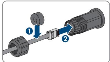
5. Kabeltülle in die Gewindehülse drücken.
