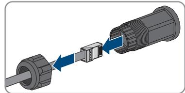
10. Schutzkappe auf Netzbuchse drehen.
