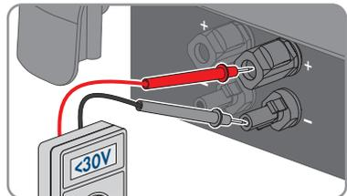
8. Spannungsfreiheit an den DC-Eingängen zwischen dem Pluspol und Erde und dem Minuspol und Erde mit geeignetem Messgerät feststellen.
