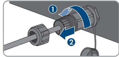
7. Den Stecker des Netzkabels entriegeln und aus der Buchse am Wechselrichter abziehen.
