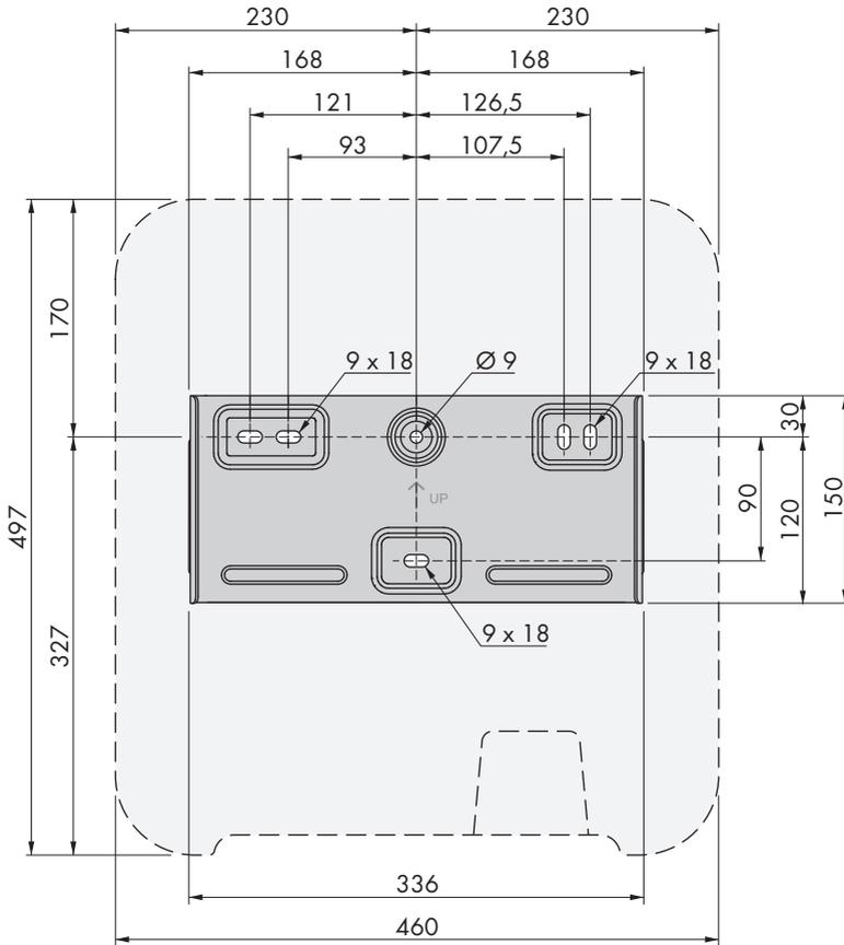
Abbildung 6: Position der Befestigungspunkte (Maßangaben in mm)
