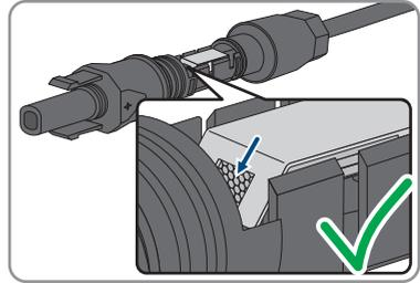
4. Wenn die Litze nicht in der Kammer zu sehen ist, sitzt das Kabel nicht korrekt und der Steckverbinder muss erneut konfektioniert werden. Dazu muss das Kabel wieder aus dem Steckverbinder entnommen werden.
