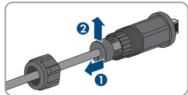
9. Das Netzkabel aus der Gewindehülse und der Überwurfmutter herausführen.
