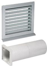
Wärmedämmende EPS Wanddurchführung für Luftkanalanschluss DN 160. Bei Nutzung der Wärmequelle Außenluft keine zusätzlichen Wärmedämmmaßnahmen um das Rohr erforderlich. Dadurch sehr einfache Installation bei geringsten Abmaßen. Inkl. Wetterchutzgitter aus silbergrau lackiertem Stahlblech. Sehr geräusch- und druckverlustarmes Wetterchutzgitter. Wetterchutzgitter mit Abtropfkante zur sicheren Vermeidung von Laufspuren an der Außenwand.
