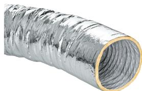
Wärmegeämmter Luftschlauch für die Außen- und Fortluftführung. Die Außenhülle besteht aus gewebeverstärktem Aluminium/Polyesterlaminat und die Innenhülle besteht aus Polyamidgewebe. Die Schlauchenden sind zur Befestigung oval verformbar. Die Zwischenlage aus Mineralwolle dient als Wärmedämmung, optional auch als Schalldämmung.
