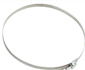
Befestigungsschelle gemäß den Normen der DIN 3017. Das Band besteht aus Edelstahl (UNI x 8 Cr 17-DIN 1.4016(W2) - AISI 430) und der Verschluss ist aus gehärtetem galvanisierten Stahl hergestellt.
