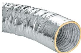
Wärmedämmter Luftschlauch für die Außen- und Fortluftführung. Die Außenhülle besteht aus gewebeverstärktem Aluminium/Polyesterlaminat und die Innenhülle besteht aus Polyamidgewebe. Die Schlauchenden sind zur Befestigung oval verformbar. Die Zwischenlage aus Mineralwolle dient als Wärmedämmung, optional auch als Schalldämmung.
