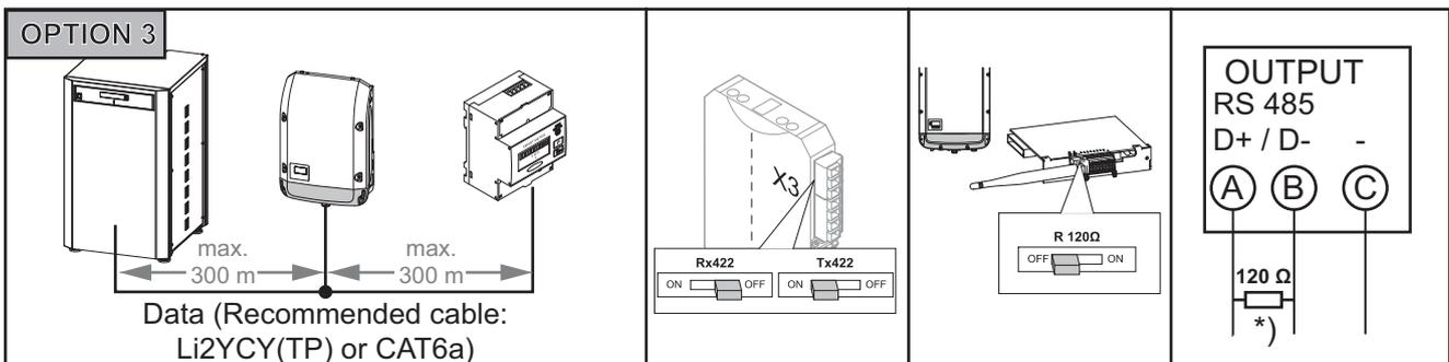
**DE** \*) Abschlusswiderstand R 120 Ohm liegt beim Fronius Smart Meter bei
